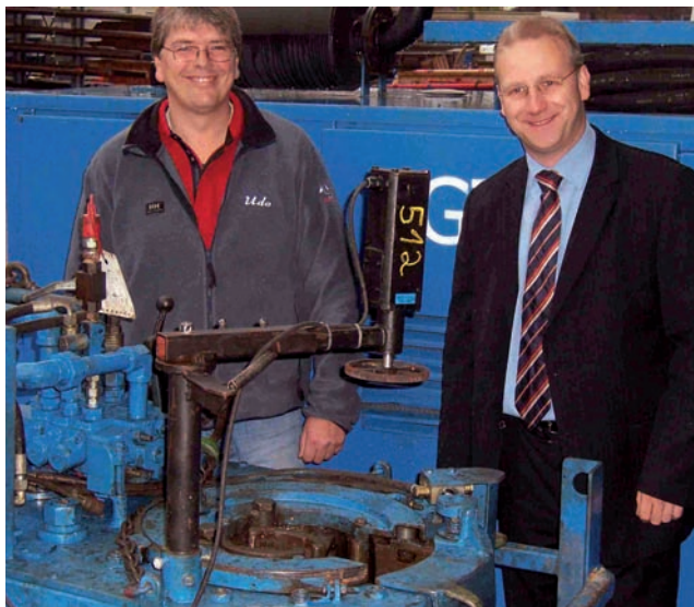
Udo Boerrigter, VD för GTS, och Leine & Lindes försäljningsingenjör Andreas Frochte bakom en 7 5/8" hydraulisk tång med en varvräknare. Räkaren är placerad runt en ATEX 632-pulsgivare.
