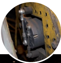
Leine & Lindes Heavy duty-givare monterad på en av gruvloken.
