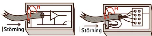
Figur 9. Kabelskärmsanslutning som kopplar in störning till kretsar i lådan.
